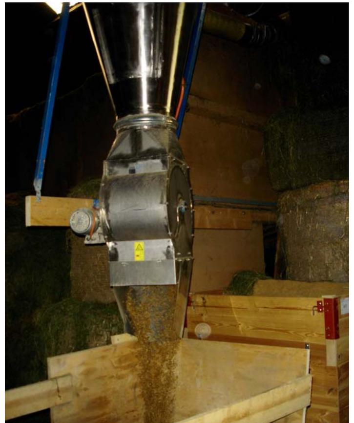
Hohe Entnahmelastungen über 100 kg pro Minute werden problemlos erreicht, die Struktur des Futters bleibt erhalten.
