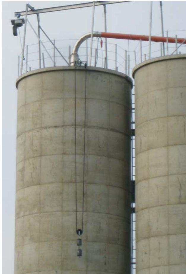
Absaugen über Niro-Bögen, Chromstahl-Ablaufleitungen oder Kunststoffrohre ist möglich. Gebläseoberteil ist schwenkbar ausgeführt.
