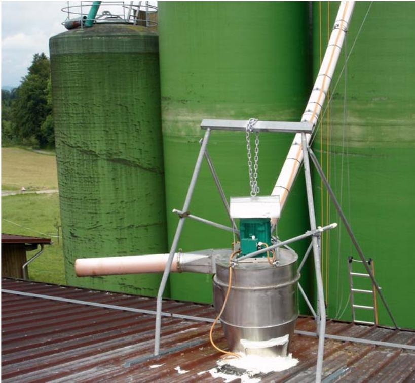
Das Turbo-Zyklon kann direkt auf das Dach gesetzt werden. Die Abluft kann über das Dach geblasen werden. Wenn zu viel Lärm entsteht, kann ein Schalldämpfer verwendet werden.
