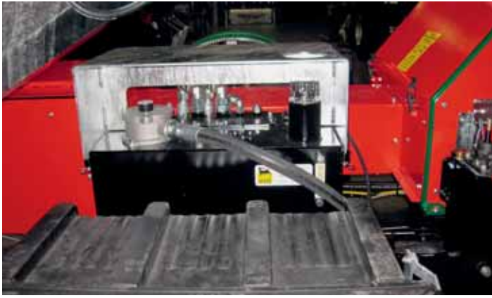
140-l-Hydrauliktank mit Rücklauffilter und Füllstandanzeige.
