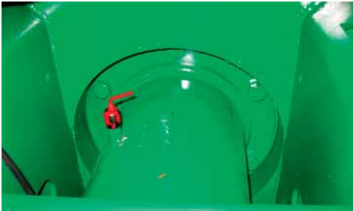
Hauptlagerung im Ölbad laufend mit herausziehbarem Ölmesstab.
