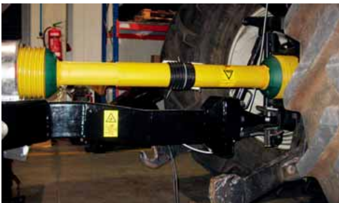
Eine massive Walterscheid-Gelenkwelle überträgt die Kraft vom Traktor zur Maismühle.
