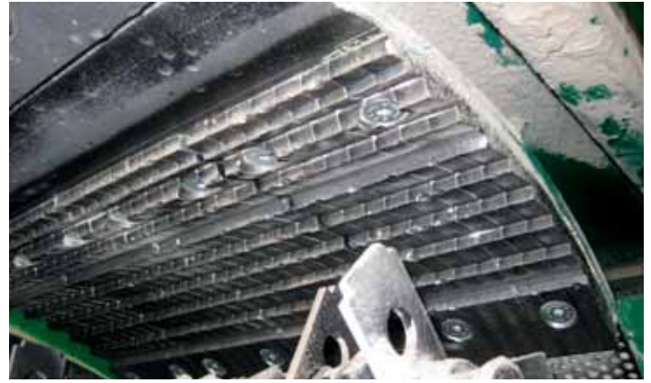
Hardox-Kornbrechblech oben sorgt für optimale Zerkleinerung (wechselbar).
