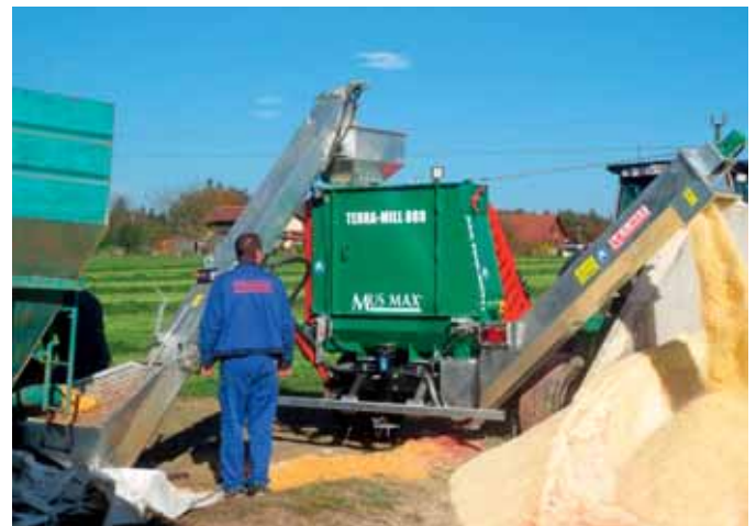
Beschickung der Zuführschnecke mit Container möglich.
