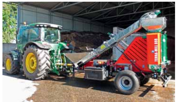
Die Zuführförderschnecke ist hydraulisch hebbar und wird für den Transport in eine sichere Ablage gelegt.
