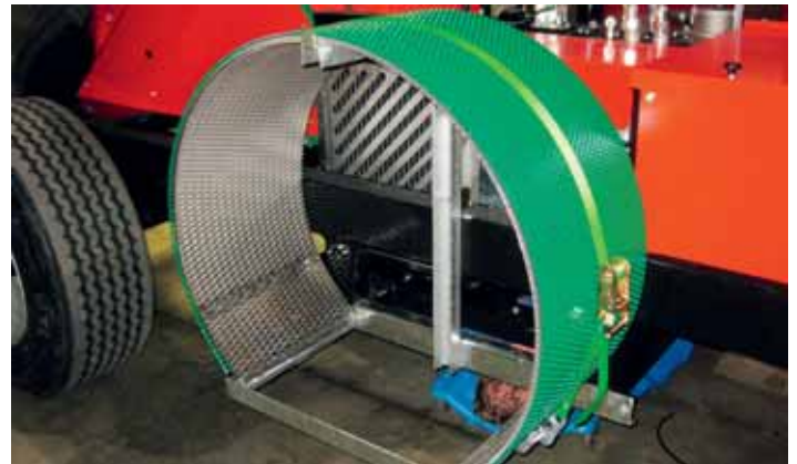
Reserve-Sieb mit Zurrgurt auf Halterung fixierbar.
