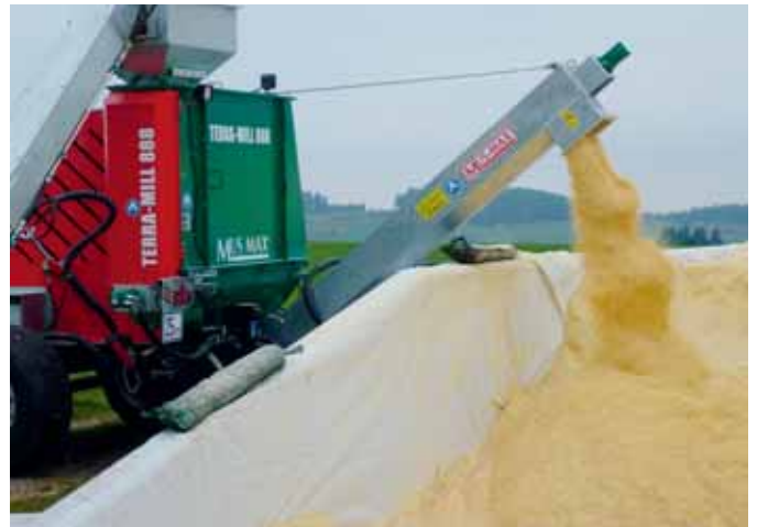
Mahlleistung bis 60 t/Std. CCM-Maiskornschrötsilage.
