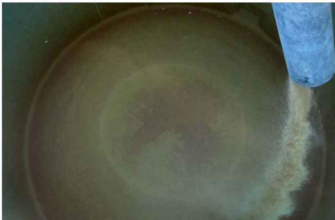
Bei größerem Silodurchmesser mit Verlängerungsrohr.
