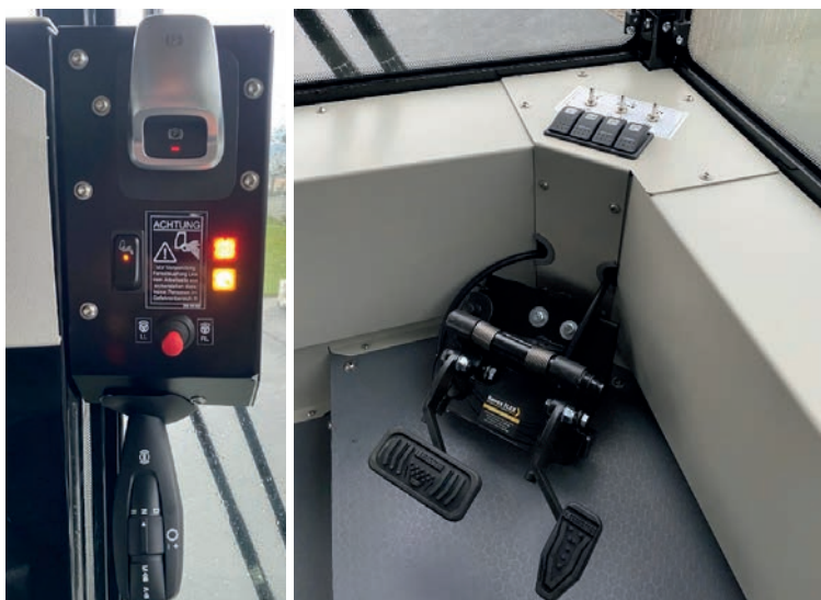
Nachfahreinrichtung mit Fußpedalen am Bediener Sitz.
