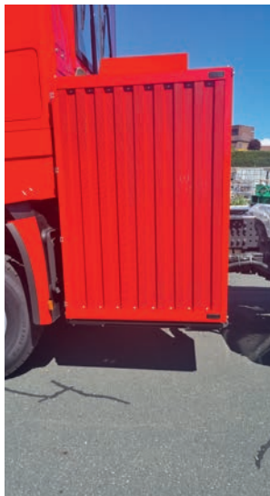
Leicht zu öffnende Kühlertüre zur raschen Reinigung.
