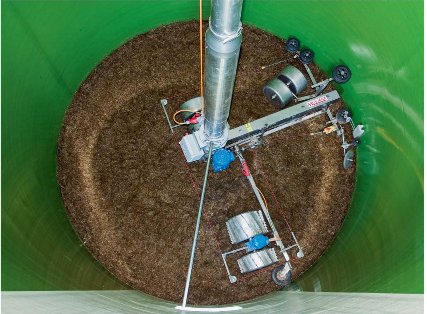
Planregler: Der Niveaueausgleich am Silostock wird mit dem oberen Tastrad auf der Siloaußenwand geregelt. Durch diesen Tastrad-Winkelhebel wird der Fräsarm angehoben und der Silostock bleibt eben. Die Drehrichtung der Entnahmefräse ist gegen den Uhrzeigersinn.
