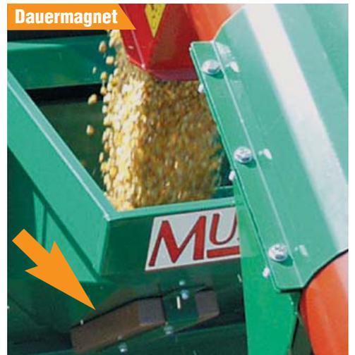
Ein Dauermagnet an der Unterseite der Einfüllgosse (Permanent-Ferrit-Plattenmagnet, Abmessungen: 310 x 155 x 50 mm) verhindert die Zufuhr von Eisenteilen im Mahlgut.
