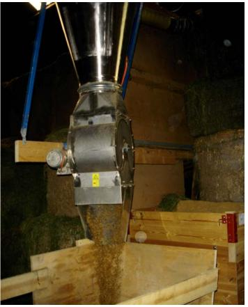
Hohe Entnahmeleistungen über 100 kg pro Minute werden problemlos erreicht, die Struktur des Futters bleibt erhalten.
