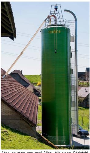
Absaugsystem aus zwei Silos. Mit einem Edelstahl-Abzweiger kann variabel aus den zwei Silos entnommen werden.
