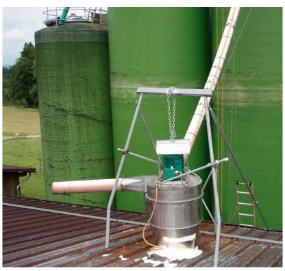
Das Turbo-Zyklon kann direkt auf das Dach gesetzt werden. Die Abluft kann über das Dach geblasen werden. Wenn zu viel Lärm entsteht, kann ein Schalldämpfer verwendet werden.
