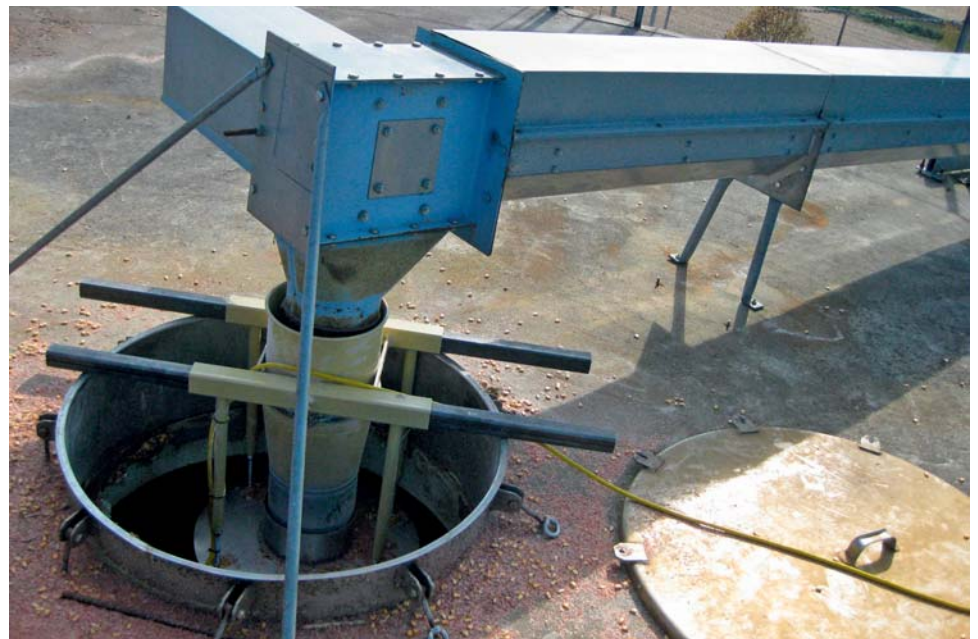
Ganzkorn-Silo: befüllen mittels Elevator.
