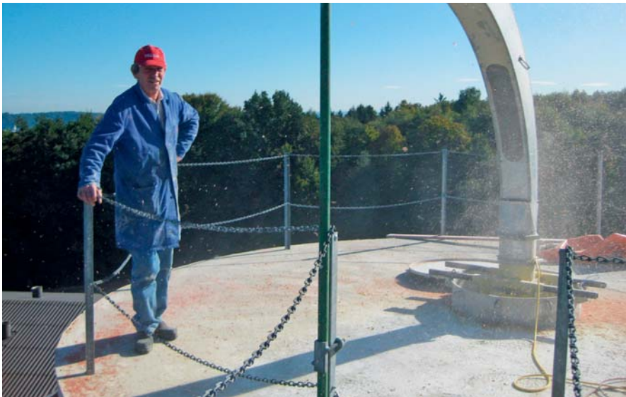
Ganzkorn-Silo: befüllen mittels Gebläse.
