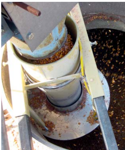
Ganzkorn-Silo: befüllen mittels Elevator.
